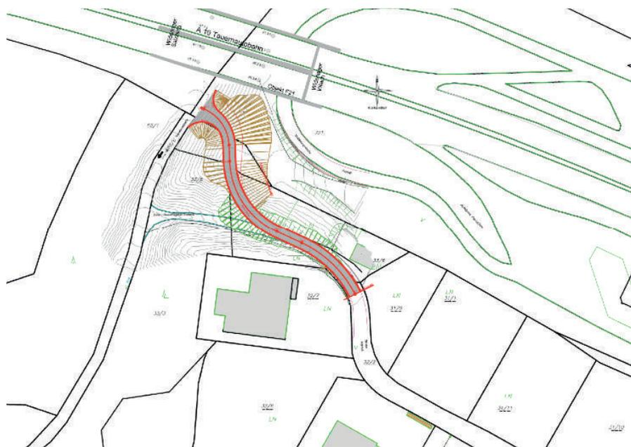
Winter. Heuer ist die Errichtung der Rohtrasse mit den Einbauten für Kanal und Wasser vorgesehen, 2016 soll diese neue und breitere Zufahrt fertig gestellt werden, die Steigung wird mit ca. 8% wesentlich verringert. Die Zusammenarbeit mit der ASFiNAG als Grundnachbar
